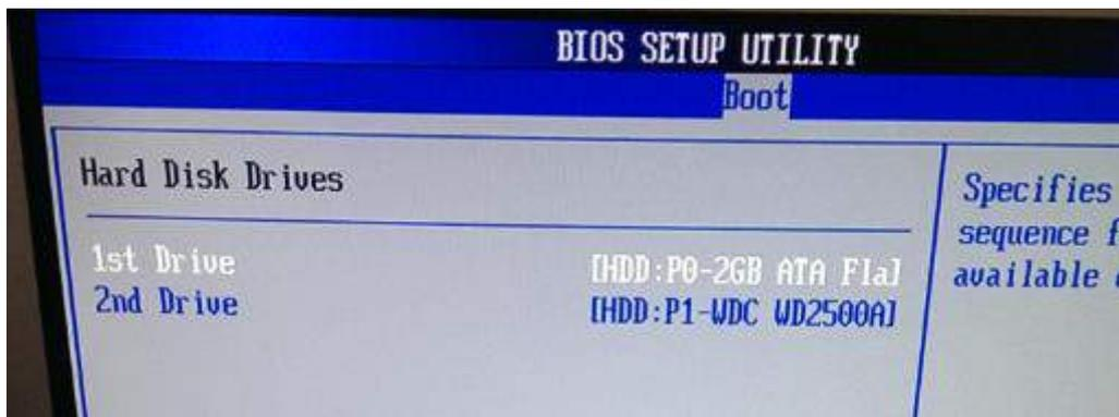
Рисунок 3.8 – Установка первого загрузочного устройства
