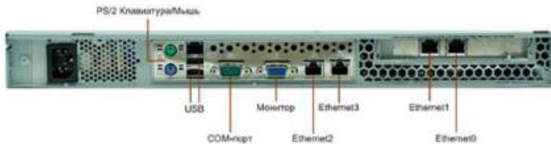
Рисунок 1.4 – Задняя панель ПАК HW1000 G2
