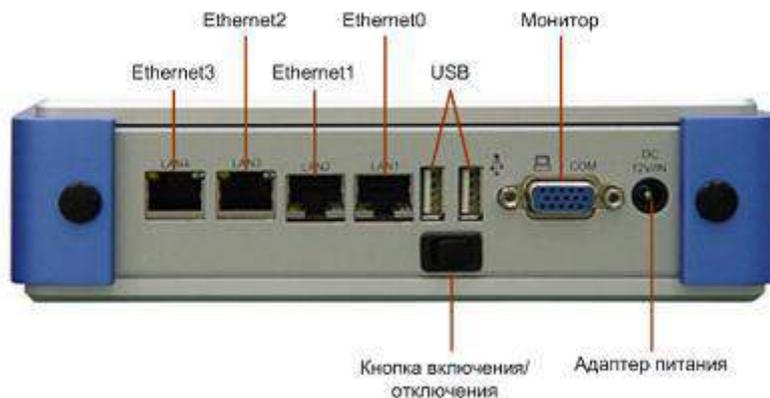
Рисунок 1.2 – Задняя панель ПАК HW100 G2
